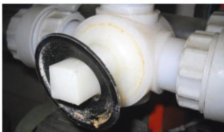
Figure 13: Des points faibles en matière d'hygiène découverts lors de visites d'étables. L'image de gauche montre une griffe avec du lait collé à l'intérieur. À droite, un robinet à trois voies avec des résidus de lait.
